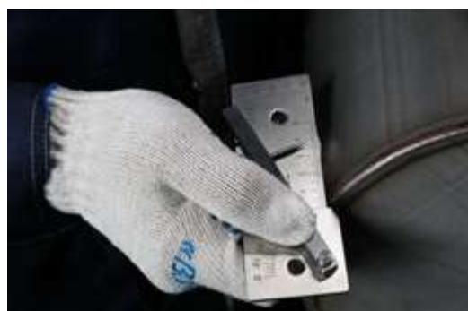
Приемо-сдаточные испытания: визуальный контроль качества сварного соединения
