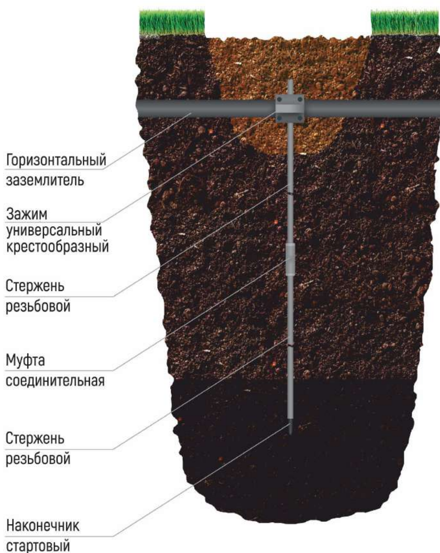
Рис. 8. Типовой глубинный электрод «КОБРА»
