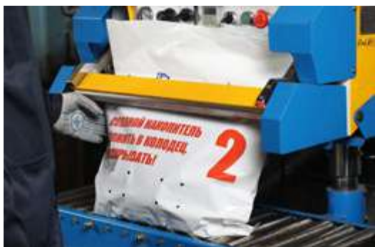
Запайка соляных накопителей для соляного модуля
