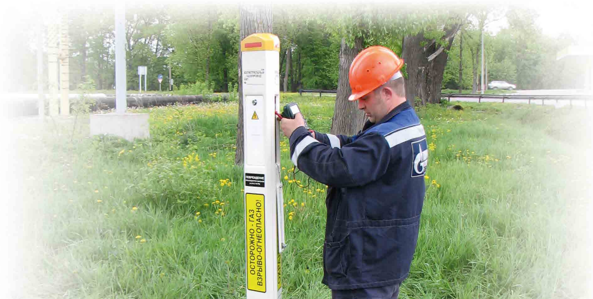
Проведение измерений на КИП ХС «Менделеевец»
